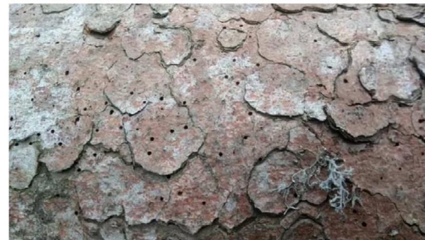
Figura 2 - Fori di uscita riconoscibili perché perfettamente tondi
