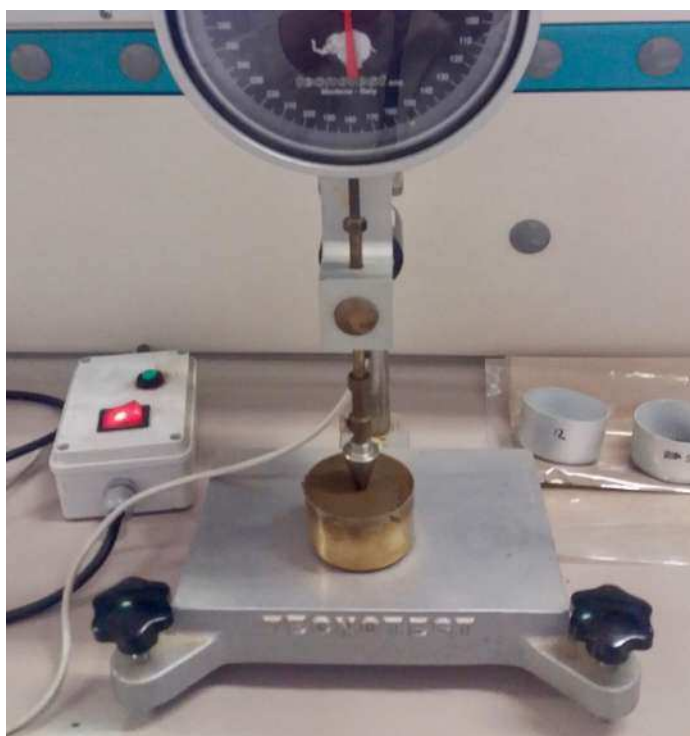
Figura 11: Penetrazione del cono sulla superficie del campione di suolo umido
