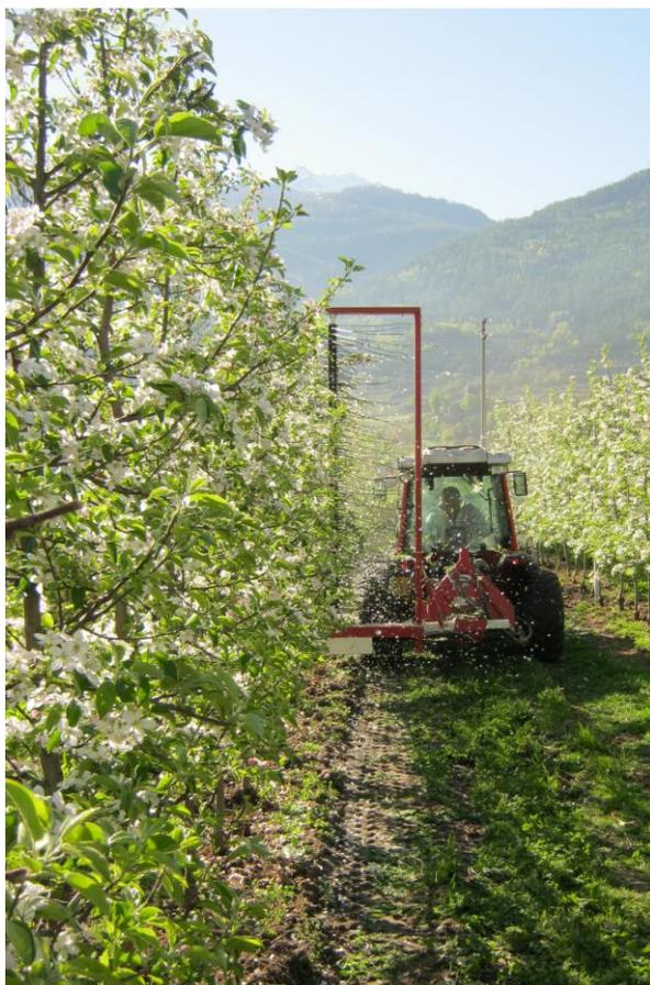
Dopo alcuni anni di lavoro ed esperimenti Hermann Gessler, frutticoltore dell'area geografica del Lago di Costanza, sviluppò questo sistema brevettato che consiste in una macchina diradante meccanica; il sistema si è affermato e ad oggi viene utilizzato in vari contesti.
