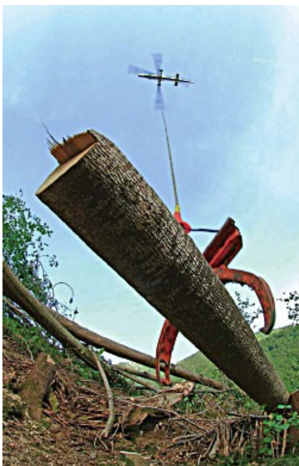
Figura 20 Esempio di pinza autoserrante (tratta dal sito www.waldwissen.net )
