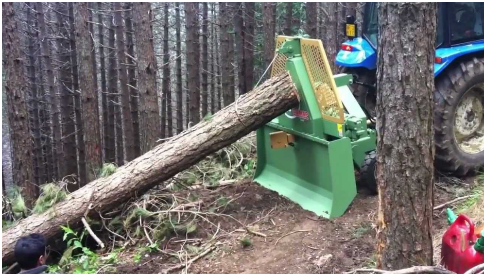
Figura 9 Esempio di verricello forestale montato su trattore forestale
