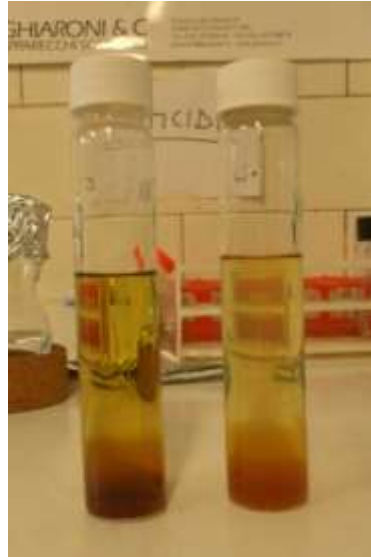
Figure 19: campioni in soluzione, dopo l'estrazione con solvente accelerato.
