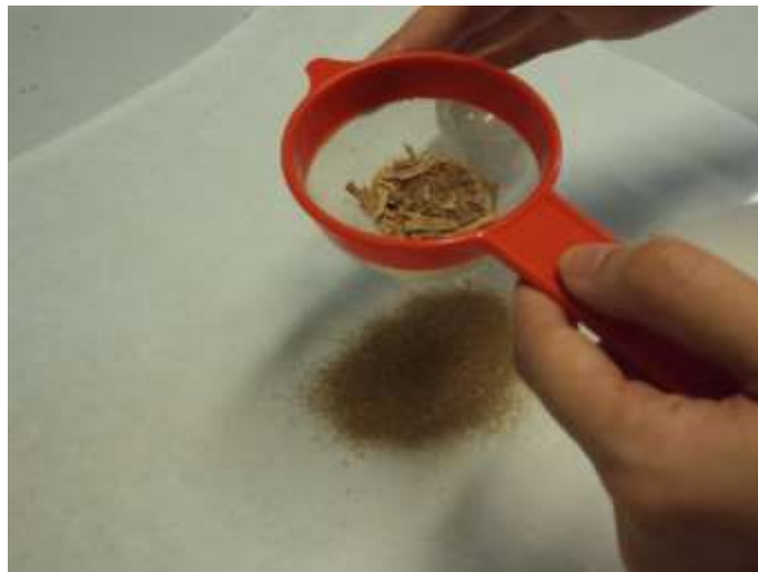
Figure 15: setacciamento dei campioni polverizzati.
