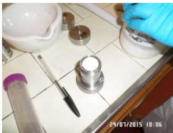
Figure 17: a) riempimento cella d'estrazione; b) cella d'estrazione.
