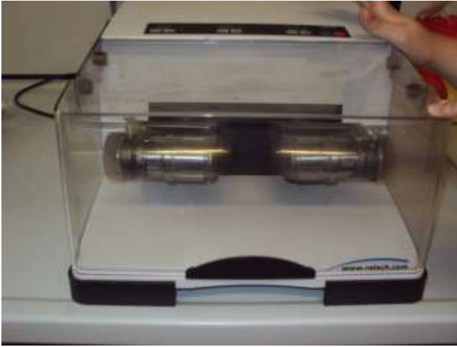
Figure 14: a) vibromulino in azione; b) tipologie di giare e sfere.
