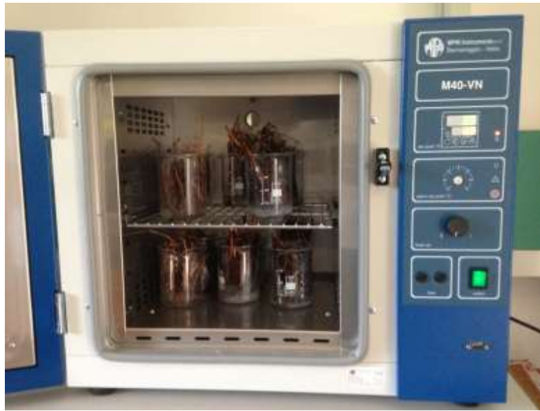
Figure 13: essiccazione dei campioni in stufa.
