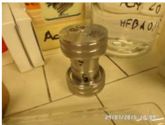
Figure 17: a) riempimento cella d'estrazione; b) cella d'estrazione.
