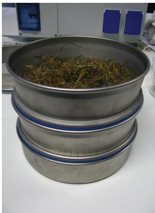
Figura 2.1 (A) Torre di setacci con maglia di diametro decrescente e fondo. (B) Soffiatore meccanico “Selecta Gravity Separator Z-1”, dove grazie al flusso d’aria regolabile le frazioni pesanti cadono nel cassetto di sinistra, mentre quelle leggere a destra.
