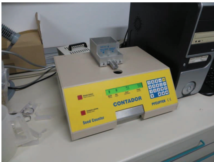
Figura 7: Dispositivo contasemi di precisione CONTADOR utilizzato per la preparazione delle provette per le sperimentazioni.
