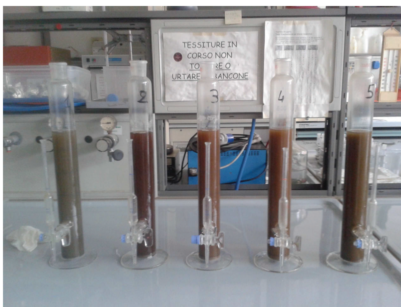
Analisi della tessitura apparente in laboratorio
