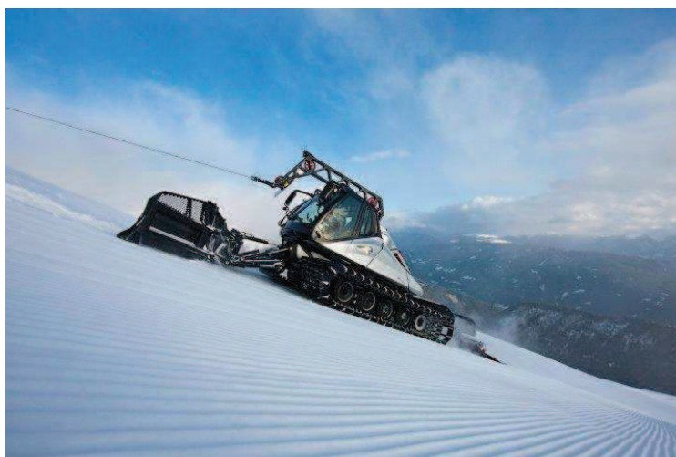
Gatto delle nevi al lavoro con l'utilizzo di verricello su una pista ad elevata pendenza
