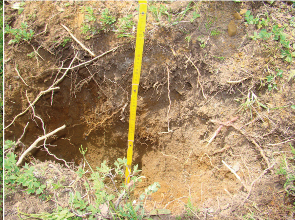
Misura della profondità del profilo
