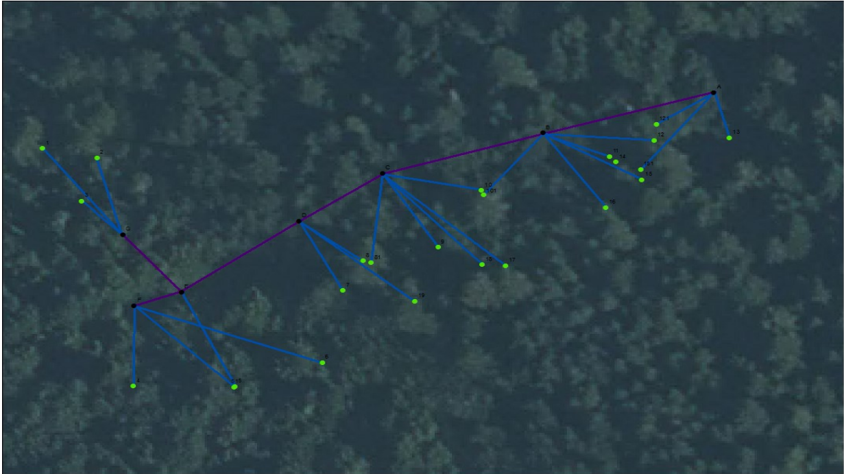
Localizzazione delle piante a partire dai punti di stazione sulla strada
