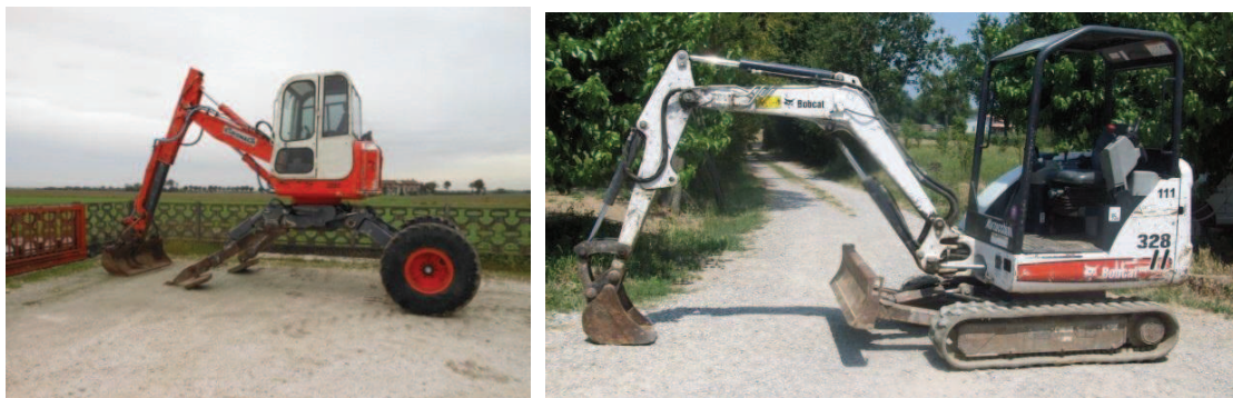
Fig. 4.26,4.27, (a sinistra),ragno meccanico ,(a destra) miniescavatore (Maines F.2009).
