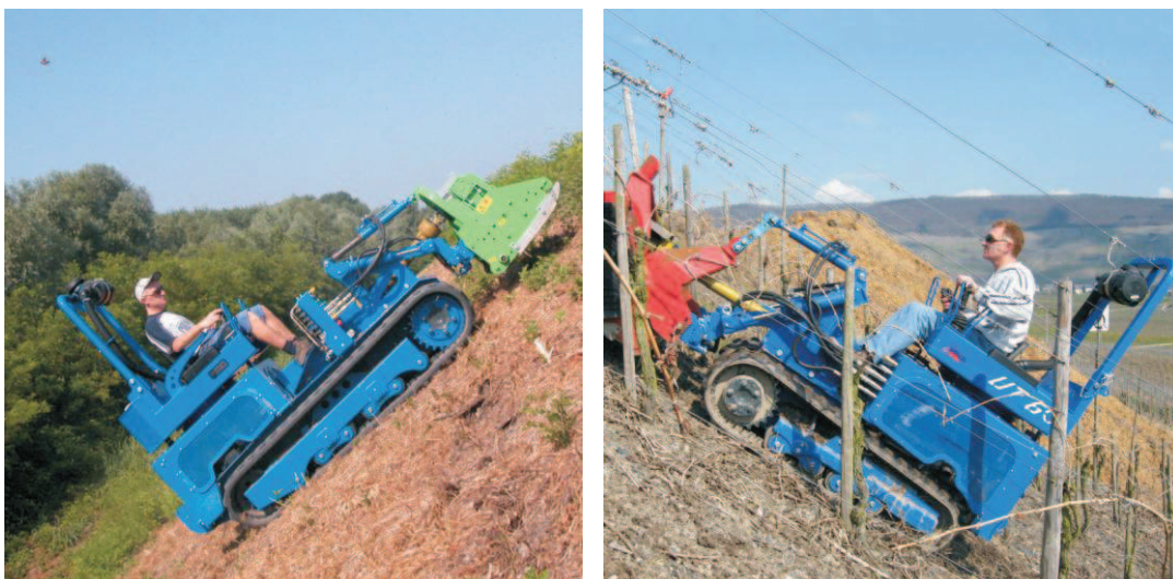
Fig. 4.48,4.49, Come si può osservare nelle foto, questo tipo di trattore permette di lavorare in condizioni di terreno e pendenze estreme, risultando un'ottima soluzione per zone disagiate come la Valtellina.( www.andreoliengineering.it )
