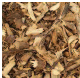
Foto 2. La dimensione e forma del cippato varia con le tecniche di taglio e dal tipo impianto di trasformazione energetica. Una dimensione tipica è 40x20x3 mm.
