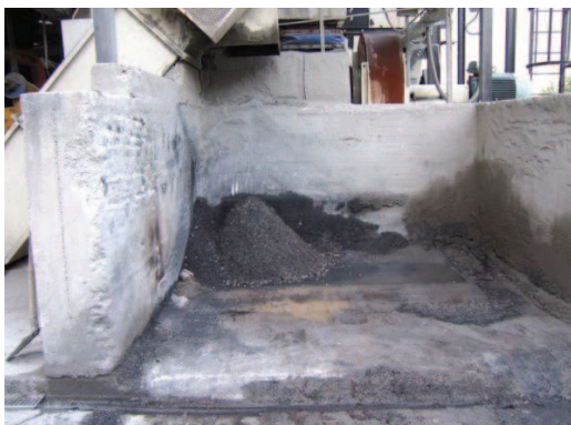
Foto 11, silo di stoccaggio cippato. Foto 12, sistema a spintori per la movimentazione automatica del cippato.
