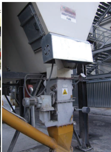
Foto 13, ceneri, residuo della combustione. Foto 14, alternatore. Foto 15, turbina a vapore. Foto 16, sistema di abbattimento fumi, costituito da filtri che consentono il recupero delle polveri sottili.
