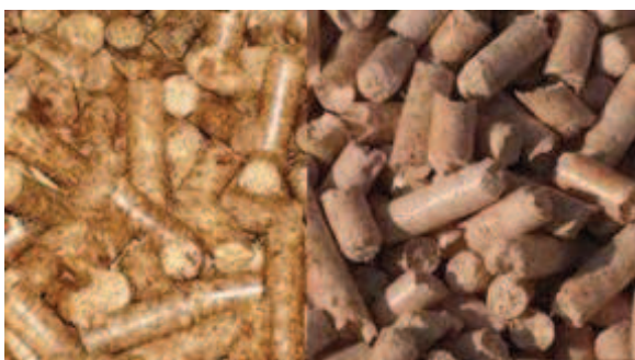
Foto 1, pellet di scarti di segheria. Anche le biomasse erbacee si prestano alla produzione di chips o pellet. Tuttavia a causa della minor qualità del combustibile, il loro impiego è consigliabile solo in impianti di grandi dimensioni dotati di opportuni accorgimenti per ottimizzarne la combustione.
