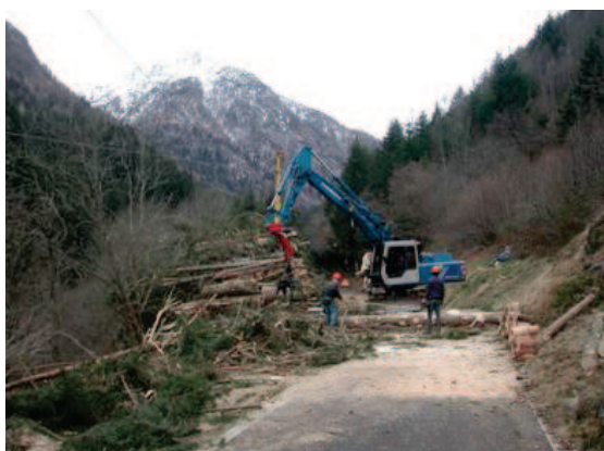
Foto 3, operazioni di sramatura e accatastamento del legname eseguite nella piazzuola ai bordi della s.p. 294. Foto 4, area di intervento dopo l’intervento di taglio.
