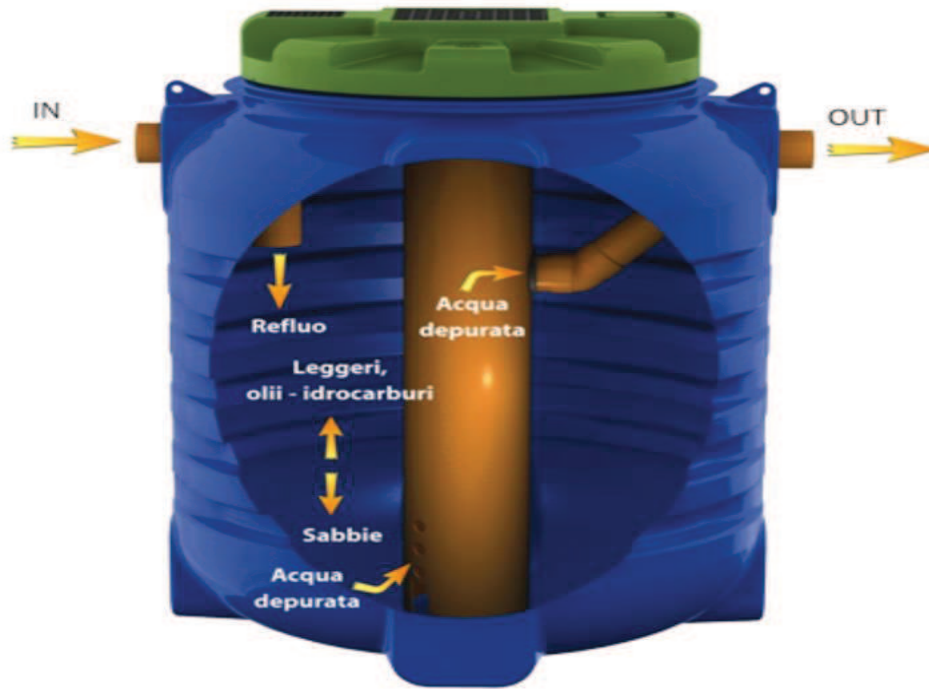
Figura 26: Schema del principio di funzionamento di disoleatore statico. (fonte: www.Dicamilloserbatoi.it )
