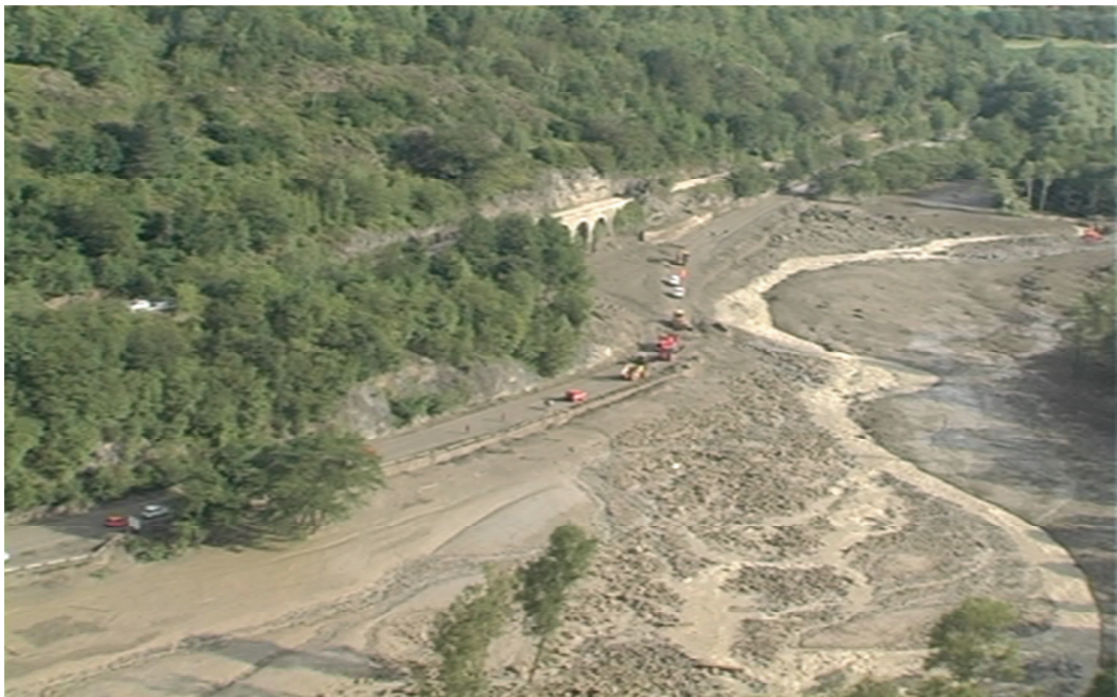
Figura 42: Foto scattata dall'elicottero, in cui si può notare come il materiale depositato dalla colata nell'alveo abbia colmato il dislivello che il fiume Oglio possedeva nei confronti della strada, circa 8 m.
