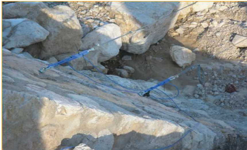
Figura 18: esempio di sensore, tipologia cavi a strappo in grado di segnalare il passaggio di una colata.
